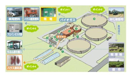
【ガス精製】バイオガスは精製圧縮することで、メタンガス用の燃焼機器が使用可能になり、用途が大きく広がります。鹿追町では温室ハウス、バイオマス自動車、一般ガス器具での使用を通して調査・研究を行っています。
