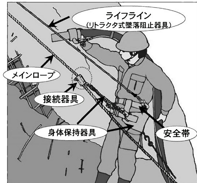
のり面保護工事でのロープ高所作業の例
